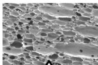
気泡が大きく、さらに穴や割れが発生。発泡ガスが逃げ、空気が流入するので、長期性能が維持できない。
