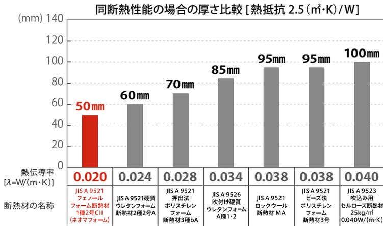
※断熱材厚さは熱抵抗に各断熱材の熱伝導率を乗じた厚さを記載。
