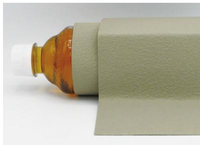
90度凹凸に折り曲げても、360度廻し曲げても剥がれ・クラックが発生していない！
