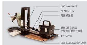
フロア上にペット(犬)を想定したすべり片付きの重錘を置き、斜め上18°の方向に所定の荷重速度で引っ張りずります。その際の引張荷重を荷重検出器で測定し、すべり片が動き出すまでの荷重の最大値を求め、次式にしたがってすべり抵抗係数「C.S.R・D」を算出します。
