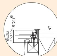
※15mm用(12mmフロア材+3mm合板)
