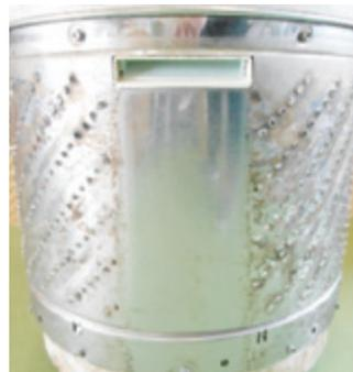
〈試験方法〉1. 洗浄試験:5年間使用した洗濯槽の汚れにウルトラファインバブル水を用いた場合の洗浄力 2. 評価方法:1日1回必ず洗濯をする条件として、1か月(30回)2か月(60回)3か月(90回)にて洗浄作用を評価(自社試験) 3. 試験期間:2017年6月~9月 4. 室温:平均18℃ 5. 水温:平均11℃ 6. 水量:16L/min 7. 試験水圧:0.3MPa 8. FB生成方式:キャビテーション方式 9. 洗濯機:Panasonic製 NA-FS70M1 7kg
