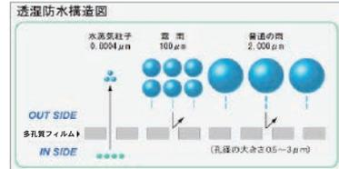
右図のように水蒸気粒子を通過させるが、霧雨、雨の分子は通過させない孔径をシートに形成させているため、透湿と防水の相反する機能を有するシートとなっています。
