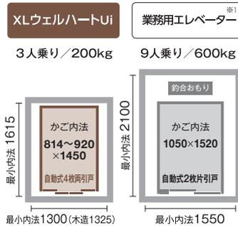
■昇降路断面図 (単位: mm)
