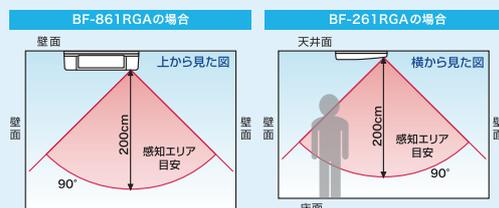
人感センサー搭載で、浴室での人の動きをセンサーが感知して自動運転します。浴室から退出後は約1分(1・2・3分で設定変更可能)で運転を自動停止します。無駄な運転をせず、安心・快適なエコ運転で経済的です。
