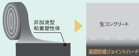
特殊な処理を行なったブチル再生ゴムが生コンクリートの水和反応の進行と同時にコンクリートとしっかり結合します。ゴム性のため、動きに追従し将来的な隙間も防ぎます。
