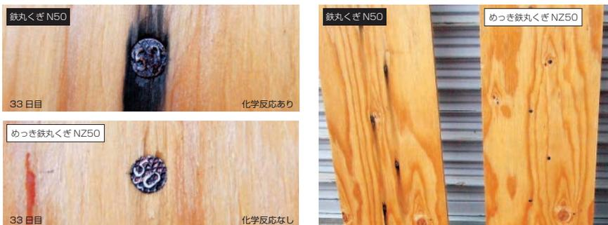
めっき未処理の一般的なくぎと亜鉛めっきを施したくぎの33日後の比較実験。左上が一般的なくぎ「鉄丸くぎN50」で既にくぎ打ち部分の周りが黒くなっている。対して、左下が亜鉛めっきを施したくぎ「めっき鉄丸くぎNZ50」で変化はおきていない。くぎ打ち部分の周りが黒くなっているのは「木材中のフェノール成分と鉄イオンとが化学反応を起こし、黒色の錯化合物を作るためである。」この化学反応を抑える為にはめっき処理が有効です。
