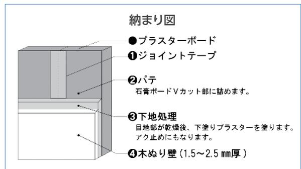
※適応下地材 不燃材料(金属板、ガラスを除く)プラスターボード、ケイカル板、ラスボード等
