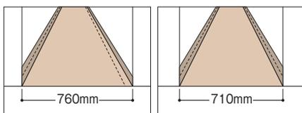
表面には50mmと100mmに折り曲げ目安になる罫線があり、裏面のスリットで簡単に折り曲げることができます。
