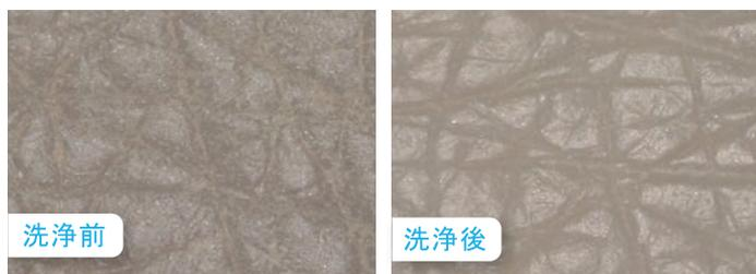
〈試験方法〉1. 恒温恒湿室にて、右手甲にファンデーションを塗布し、ウルトラファインバブル水で10秒間洗浄。洗浄前、洗浄後をマイクロスコープにて観察した(自社試験) 2. 試験期間：2017年3月7日 3. 被験者：2名(男性：43才 女性：41才) 4. 室温：23℃ 5. 水温：40℃ 6. 水量：10L/min 7. 測定機種：マイクロスコープ HIROX KH-1300 8. FB生成方法：キャビテーション方式 9. シャワーヘッド：SANEI(株)製 PS39-80X
