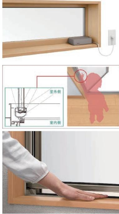
■手の届かない場所でもチェーンを使わずに開閉できる高所用横すべり出し窓の電動ユニット。
