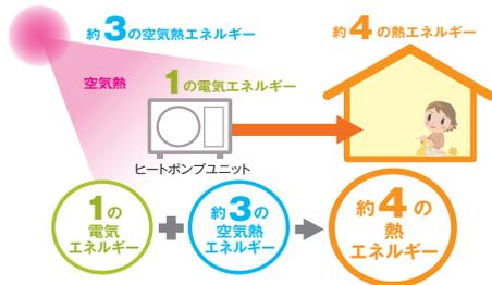
エコダンデーは「1」の電気エネルギーを使い、約「3」の空気熱エネルギーをくみ上げ、約「4」の熱エネルギーを生みだし、温水をつくります。
