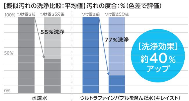
※水質、環境、よごれや洗剤の種類により効果は変動します。※キレイストで生成したウルトラファインバブルを含んだ水(試験水)と、タカギ本社所在地:北九州市の水道水(比較水)を使用。「マスク想定」の綿製の布:綿100%に「口紅0.1g+メイク落とし2.4mlの混合液」を0.05ml塗布し10分乾燥させ、試験水:比較水各500mlに洗剤0.5mlを加えた水に5分間浸漬。その後、5分間自然乾燥させた検体をコニカミルタ製:分光測色計CM-2600Dを用いて、それぞれ浸漬前と後の汚れの色差(ΔE\*ab:デルタ・イースター・イー・ビー)を測定。試験水と比較水それぞれの色が落ちた程度を示す「色落率=(塗布後色差-洗浄後色差)/塗布後色差」を算出し、その比(試験水の色落率/比較水の色落率)を洗浄率比とした。12回の試験を行ってn=12の洗浄率比を算出し、その平均を結果(約40%アップ)とした。(2020年10月タカギ開発調べ)
