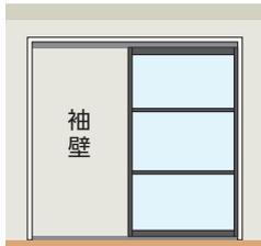
アウトセット(枠外天井付け)納まり
