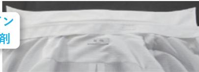
〈試験方法〉1. 洗浄試験:同種のYシャツを1年間、ウルトラファインバブル水と水道水により同条件により洗濯を繰り返した場合の衣類汚れの比較を実施 2. 試験期間:2017年8月21日~2018年8月20日 3. 被験者(着用者):株式会社富士計器 工場担当2名(自社試験) 4. 室温:平均17℃ 5. 水温:平均水温:10℃ 6. 水量:16L/min 7. 試験水圧:0.3MPa 8. 使用洗剤:液体洗剤(使用量25g/37L) 9. FB生成方式:キャビテーション方式 10. 洗濯機:Panasonic製 NA-F70PB10 7kg
