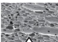
気泡が大きく、さらに穴や割れが発生。発泡ガスが逃げ、空気が流入するので、長期性能が維持できない。
