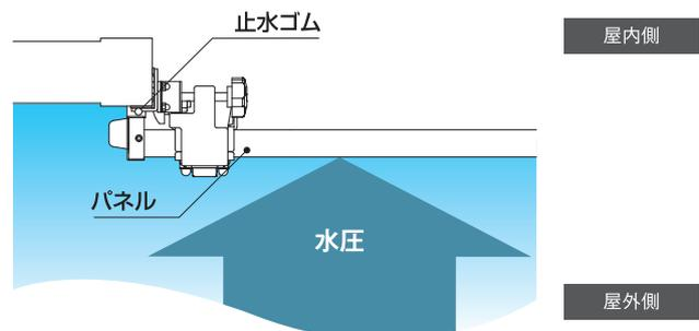
水かさが増すと水圧で建物と止水板が密着します。
