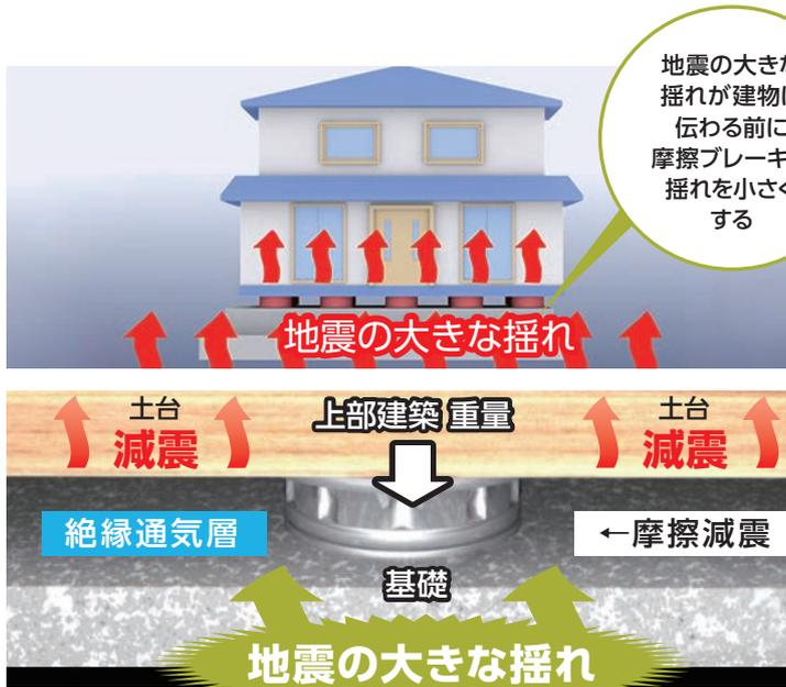
UFO-Eは、建物と基礎の間に設置する「減震パッキン」で、地震の大きな揺れが建物に直接伝わる前に摩擦のブレーキで揺れを小さくして減震します。
