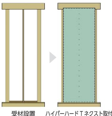
ハイパーハードTネクストを使用することによって、施工の工程(間柱の欠き込み、金物設置)が減り、施工手間の省略に繋がります。また、断熱材施工も簡易化出来ます。
