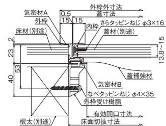
■ スピードクリッパー使用時(置床工法)
