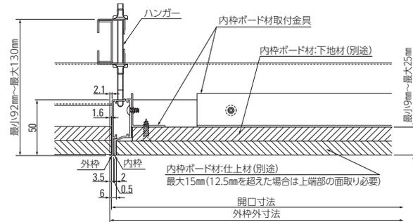
**>>内枠ボード材の加工寸法**
