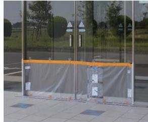
止めピタは約5分で設置完了
