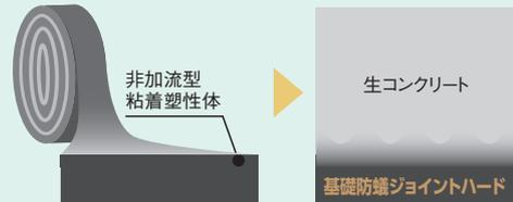
特殊な処理を行なったプチル再生ゴムが生コンクリートの水和反応の進行と同時にコンクリートとしっかり結合します。ゴム性のため、動きに追従し将来的な隙間も防ぎます。
