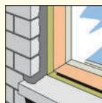
屋外や屋内の隙間、目地へ充填することで気密性及び断熱・防音に効果があります。
