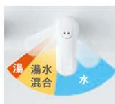
水だけ使うつもりでも、気づかないうちに給湯機が作動しがちだった従来品。エコシングル水栓なら、レバー中央部まで水のみ吐水。しかも、湯との境に「カチッ」というクリック感を設け、お湯のムダ使いを防げます。
